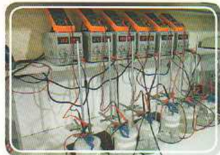
◀ شنمایی از سلول‌های آزمون الکتروشیمیایی آندهای MMO
