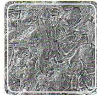
ساختار میکروسکوپی پوشش آندهای MMO
